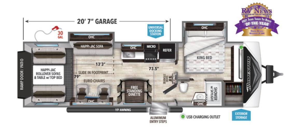
30G UVW<sup>1</sup> HITCH<sup>1</sup> GVWR LENGTH<sup>2</sup> HEIGHT CAPACITY 20'7"GARAGE 8,800 1,350 13,000 34'11" 12'4" 100 78 39
