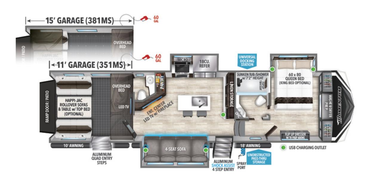
351**MS** UVW<sup>†</sup> HITCH<sup>†</sup> **GWVR** LENGTH<sup>‡</sup> CAPACITY HEIGHT 38'6" 13' 5" 155 78 78 13,800 2,785 16,800 11' GARAGE 381**MS** UVW<sup>†</sup> HITCH<sup>†</sup> **GWVR** LENGTH<sup>‡</sup> CAPACITY HEIGHT 42'9" 155 78 78 14,700 2,800 20,000 13'5" 15' GARAGE
