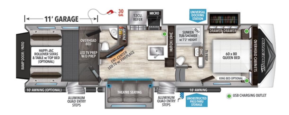
320G UVW<sup>†</sup> HITCH<sup>†</sup> GVWR LENGTH<sup>‡</sup> HEIGHT CAPACITY 11' GARAGE 12,400 2,300 16,800 36' 3" 13' 5" 115 78 78
