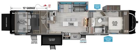
399**TH** UVW<sup>1</sup> HITCH<sup>1</sup> GVWR LENGTH<sup>2</sup> HEIGHT CAPACITY 13' GARAGE 15,900 3,400 22,500 43' 1" 13' 6" 140 104 104
