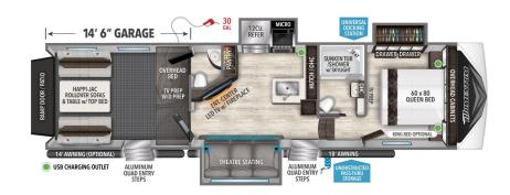
350G UVW HITCH GVWR LENGTH HEIGHT CAPACITY 14'6" GARAGE 12,950 2,600 16,800 39'10" 13'5" 115 78 78
