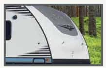
TRAVEL TRAILER GEL-COAT FIBERGLASS CAP
