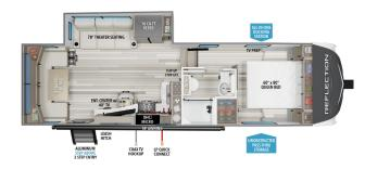
UVW<sup>1</sup> HITCH1 LENGTH<sup>2</sup> HEIGHT<sup>3</sup> CAPACITY 260RD 29' 9" **55** 71 39 8,534 1,269 12'
