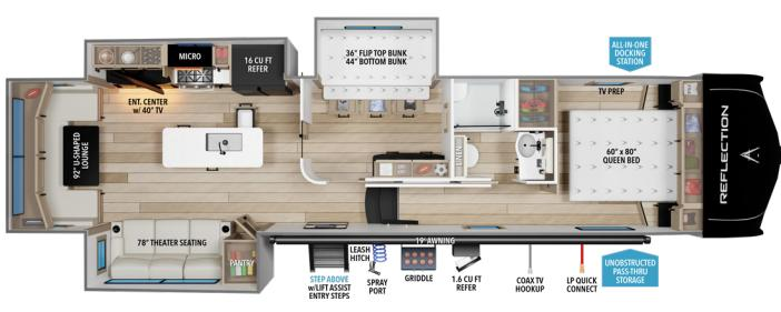
**324MBS**      UVW<sup>1</sup> 11,200      HITCH<sup>1</sup> 2,000      LENGTH<sup>2</sup> 37'      HEIGHT<sup>3</sup> 13' 1"      CAPACITY 74 78 39
