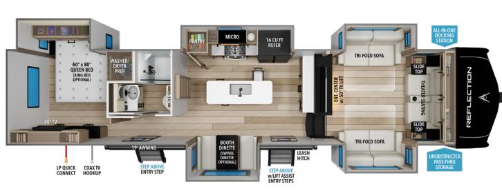
**360FLS**      UVW<sup>1</sup> 12,388      HITCH<sup>1</sup> 2,600      LENGTH<sup>2</sup> 39' 2"      HEIGHT<sup>3</sup> 13' 3"      CAPACITY 74 78 39
