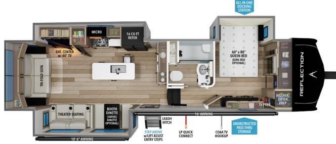
**337RLS**      UVW<sup>1</sup> 11,200      HITCH<sup>1</sup> 2,300      LENGTH<sup>2</sup> 35' 7"      HEIGHT<sup>3</sup> 13' 3"      CAPACITY 74 79 39
